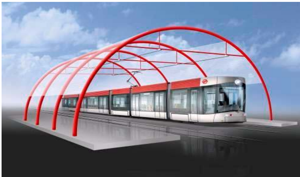
Bild 4: Projektbild einer Haltestelle mit Nachladefunktion über den Stromabnehmer
