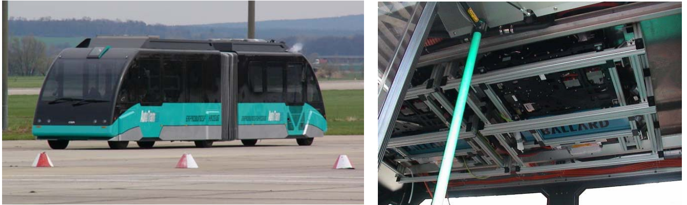
Abb. 2-8: AutoTram auf dem Testgelände und HY80-TwinCluster im Dachbereich
