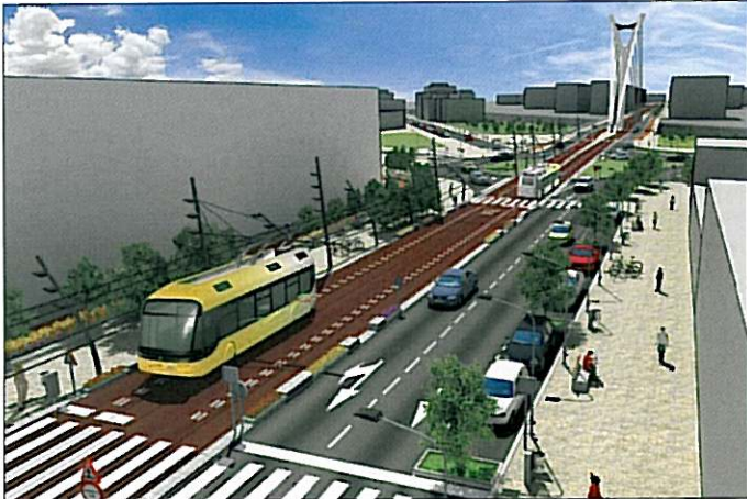
Computergraphik einer Trasse für optisch spurgeführte Obusse in Castellón Abbildung: D. Catanzaro
